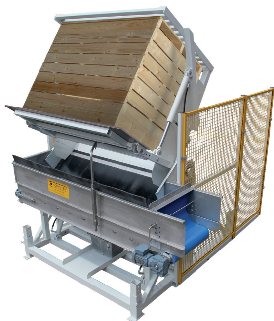
Wywrotnica skrzyń z taśmociągiem wyladowczym w pozycji wysypywania
